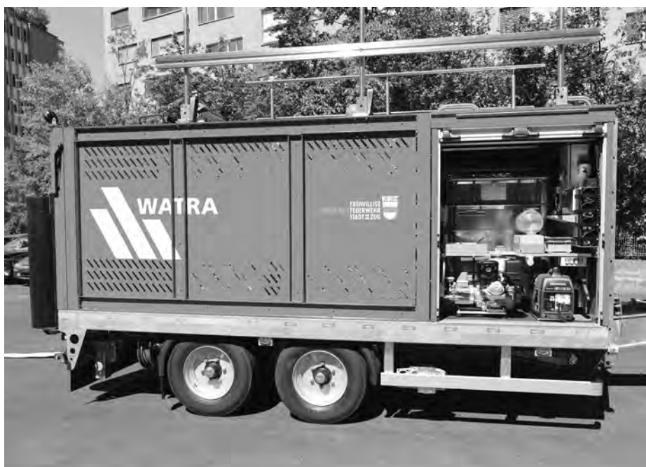
Moderner, neuer Schlauchverlegeanhänger.
