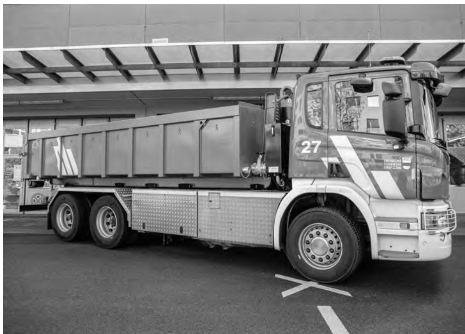
Zu einem Ausgleichsbecken umgebaute Mulde für den schweren Wassertransport.
