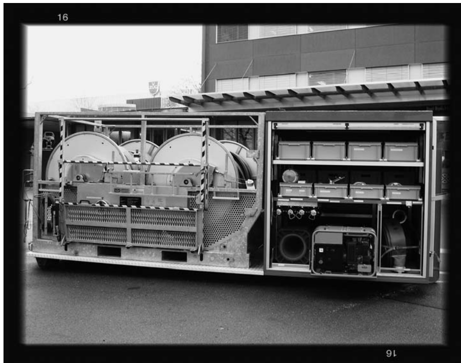
Verstärkung für den schweren Wassertransport: die neue Schlauchverlegebrücke.
