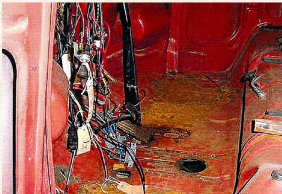
Zustand vor der Instandstellung 2004: Rost so weit das Auge reicht
