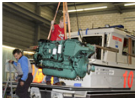
Die alten Motoren werden ausgebaut
