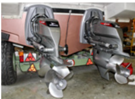
Die Z-Antriebe sind eingepasst und bereit
