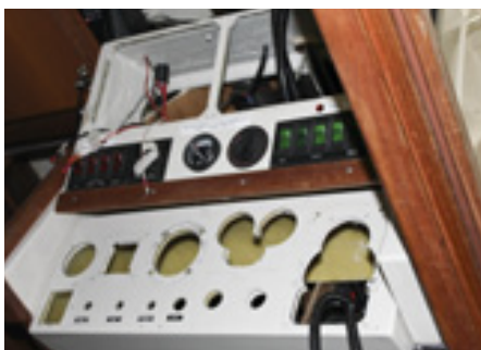
Alle alten Instrumente im Steuerhaus werden entfernt
