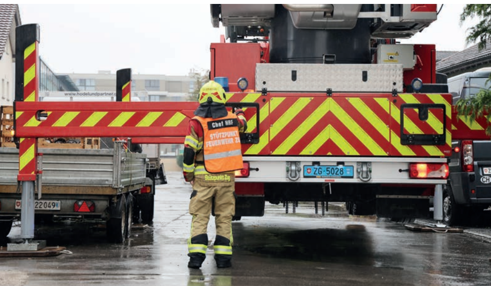
Neue gelb-rot-reflektierende Folie am Fahrzeugheck.
